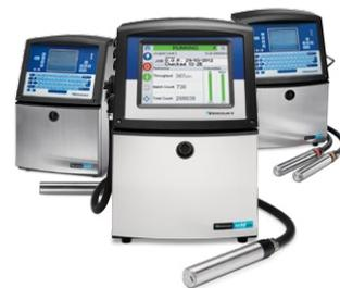
CIJ 喷码可以在多种产品上进行非接触式编码。使用 CIJ 技术时，墨滴流通过喷印头喷射，附着到喷印表面上。墨滴流通过喷嘴从打印头喷出，随后超声波信号会使喷墨形成细小的墨滴。这些独立的墨滴之后会从墨滴流中分离出来，经过充电后，发生偏移，形成点阵，飞出喷头，最后喷射在产品上，形成字符。无论是平整还是不规则的，CIJ 喷码机几乎可以在任何表面进行清晰地喷印，并且可以在产品的侧面、顶部、底部甚至内侧喷印编码。非常适合用于凸面、凹面、不规则表面、极微小或难以触及的表面，这就是非接触式喷印方法的优势所在。
